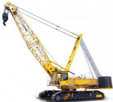
Гусеничный кран XCMG XGC150-1 - это грузоподъемная техника типа самоходного крана. Он является частью серии XGC от компании XCMG и предназначен для перевозки с объекта на объект автотранспортом, что позволяет сократить эксплуатационные расходы. Кран имеет грузоподъемность 150 тонн, максимальную длину основной стрелы в 76 метров и максимальную высоту подъема в 95 метров. Он может использоваться на любой площадке без подготовительных работ.
