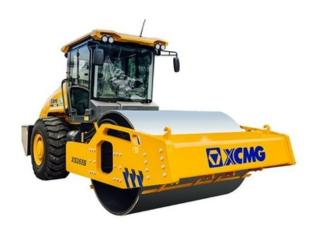
Гидравлический одновальцовый полноприводный каток XCMG XS265S - это комбинированное строительное оборудование, предназначенное для уплотнения различных типов грунта. Он широко применяется в строительстве дорог, аэродромов и при благоустройстве территорий.
