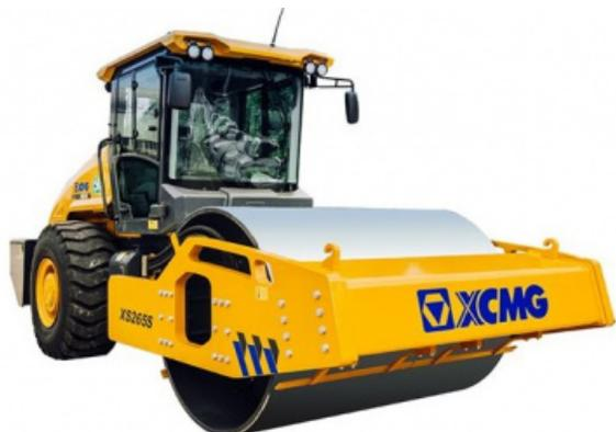
Одновальцовый грунтовый каток с механическим приводом XCMG XS265JS - это эффективное и энергосберегающее строительное оборудование, специально разработанное для уплотнения грунта. Он может использоваться для уплотнения различных материалов, включая гальку, песок, моренный грунт, взрывные породы и глину. Каток также подходит для уплотнения бетона и стабилизированных грунтов на различных крупномасштабных строительных проектах.
