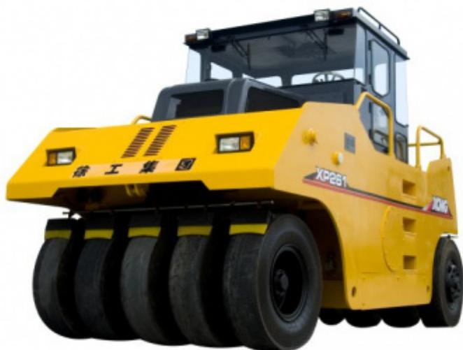
Современный дорожный каток XP263K является высокотехнологичным оборудованием, предназначенным для утрамбовки и уплотнения грунтов и асфальтобетона. Он оснащен вальцом, размещенным на колесах (передних и задних), и обладает значительной эксплуатационной массой, что позволяет достичь эффективного уплотнения поверхностей.
