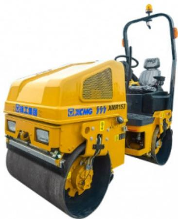
XCMG XMR153 - это двухбарабанный вибрационный дорожный каток, который используется для уплотнения асфальта, гравия, песка и других материалов. Он особенно подходит для укладки асфальта в узких местах, таких как бордюры и траншеи. Данный каток имеет компактные габариты и хорошую мобильность, что обеспечивает комфортную эксплуатацию в условиях ограниченного пространства.
