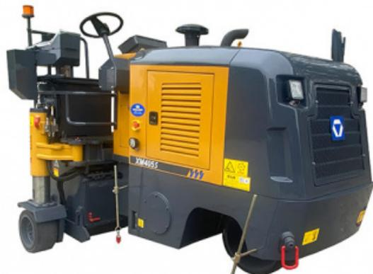
Дорожная фреза XCMG XM405 предназначена для обслуживания городских улиц и проселочных дорог. Она может фрезеровать мелкомасштабное дорожное покрытие и оснащена задними ножками для подъема и функцией фрезерования в форме клина. Фреза также имеет индикатор глубины фрезерования и систему автоматического выравнивания.
