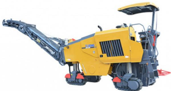
Фреза дорожная XCMG XM1305F - это специализированное оборудование, которое используется для снятия верхнего слоя асфальта путем фрезерования на заданную глубину. Она имеет мощность двигателя 280 л.с., эксплуатационную массу в 21 тонн и габариты (ДхШхВ) 9950×2180×3000 мм.
