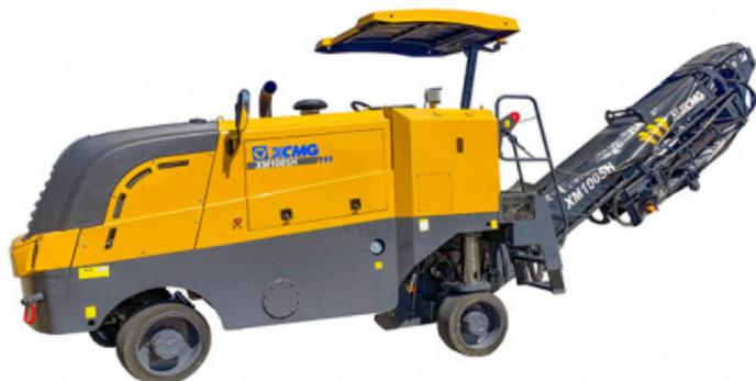
Дорожная фреза XCMG XM1005H используется для снятия верхнего слоя асфальта на заданную глубину и применяется для ямочного (заплаточного) ремонта, устранения асфальтовой колеи, срезания широкой полосы при реконструкции дороги и для создания плавного перехода. Она имеет эксплуатационную массу 13,3 т, мощность двигателя 223 л.с. и габариты (ДхШхВ) 9580×2300×2650 мм.
