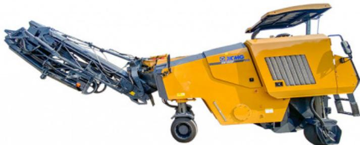
Дорожная фреза XCMG XM1005F - колесная машина, предназначенная для фрезерования верхнего слоя асфальта на заданную глубину до 150 мм. Она используется для ямочного ремонта, снятия асфальтовой колеи, полноценной реконструкции дороги и создания плавного перехода между свежееуложенным и старым полотном. Ее эксплуатационная масса составляет 16 тонн, ее двигатель выдает 250 л.с., а габариты составляют 9100 × 2010 × 2900 мм.
