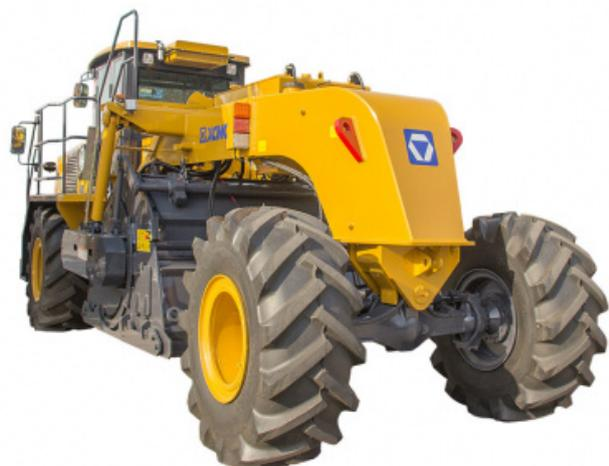
Ресайклер XCMG XLZ2103S - мощная машина для фрезерования и перемешивания дорожного полотна с вяжущим материалом и грунта с добавлением стабилизирующих веществ. Его эксплуатационная масса составляет 21,0 т, а мощность двигателя - 460 л.с. Машина имеет ширину фрезерования 2100 мм и максимальную глубину фрезерования 400 мм, а также две скорости - 2,7 и 18,5 км/ч. Размеры машины - 9 232 × 3 142 × 3 450 мм, а модель двигателя - WEICHAИ WP12.460N. Шины: передние 23,5-25 / задние 23,5-25.
