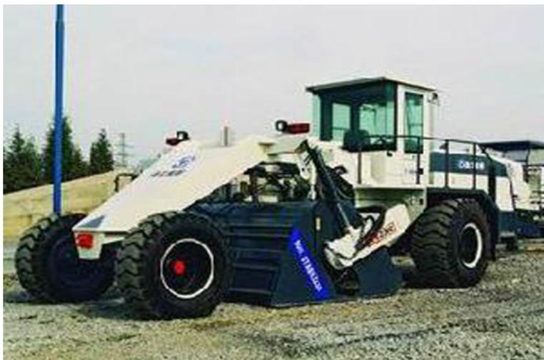
Стабилизаторы грунта могут применяться для сфрезеровывания старого, изношенного дорожного полотна, его моментального перемешивания с новым вяжущим материалом, а также для перемешивания грунта с добавлением стабилизирующих веществ.
