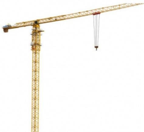
Кран башенный XCMG XGT6013-6S1 - это надежный кран с грузоподъемностью 6,0 тонн. Он обладает грузоподъемностью на конце стрелы весом до 1,3 тонн. Максимальный грузовой момент составляет 100 т\*м, что обеспечивает высокую эффективность и производительность при подъеме и перемещении грузов.
