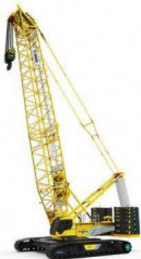
Гусеничный кран XCMG XGC100-1 - грузоподъемная машина на гусеничном ходу с решетчатой стрелой, имеющая класс грузоподъемности 100 тонн. Максимальная длина основной стрелы составляет 61 метр, а максимальный грузовой момент - 360 кН\*м. Он широко применяется в различных отраслях промышленности и коммунального хозяйства благодаря своей высокой грузовой характеристике и устойчивости.
