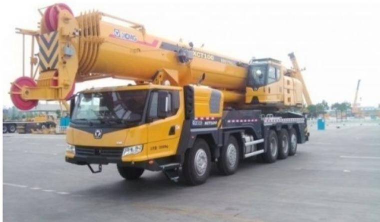
Мобильный колесный кран XCMG XCT100 S сконструирован с использованием принципиально новой гидравлической системы, которая получила в Китае 6 государственных патентов. Колесный автокран XCMG XCT100 S характеризуется отличными показателями проходимости. Низкий центр тяжести обуславливает хорошую устойчивость, как во время движения, так и при выполнении крановых работ.
