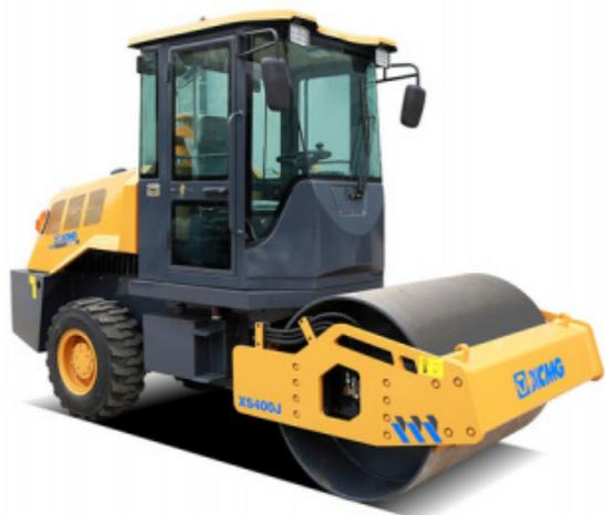
Механический одновальцовый виброкаток XCMG XS45J - это мощное оборудование для уплотнения грунтов, включая песок, гальку, глину и взрывные породы. Кроме того, он подходит для работ с бетоном и стабилизированными грунтами в различных проектах. Он имеет эксплуатационную массу 4,0 тонны, мощность двигателя 49 л.с. и небольшие габариты (3960x1500x2730 мм). Каток оснащен приводом на задних колесах и может развивать скорость до 7 км/ч. Модель двигателя - Changchai.
