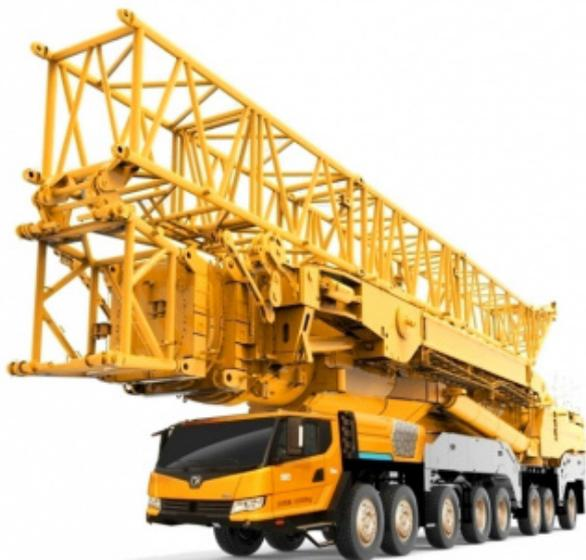
ХСА1200 - это впечатляющий внедорожный автокран, который способен поднимать грузы вплоть до 1200 тонн. Он оснащен специальным шасси повышенной проходимости, которое имеет колесную формулу 16x12x16. Это означает, что автокран имеет 16 колес, из которых 12 являются приводными, а оставшиеся 4 - поворотными.
