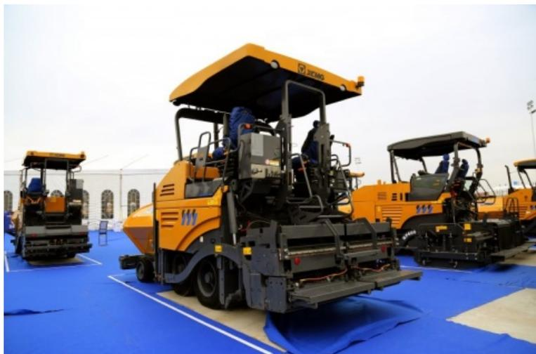
Асфальтоукладчик XCMG RP603L предназначен для укладки асфальтного покрытия при строительстве дорог, а также для асфальтирования тротуаров и промышленных площадей.
