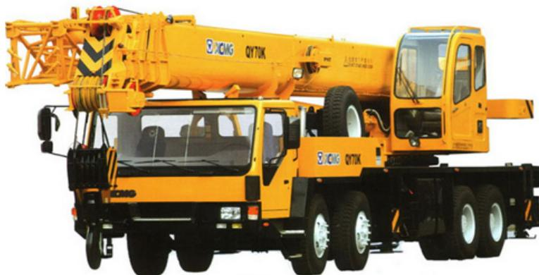
Мобильный колесный кран XCMG сконструирован с использованием принципиально новой гидравлической системы, которая получила в Китае 6 государственных патентов. Колесный автокран XCMG характеризуется отличными показателями проходимости. Низкий центр тяжести обуславливает хорошую устойчивость, как во время движения, так и при выполнении крановых работ.
