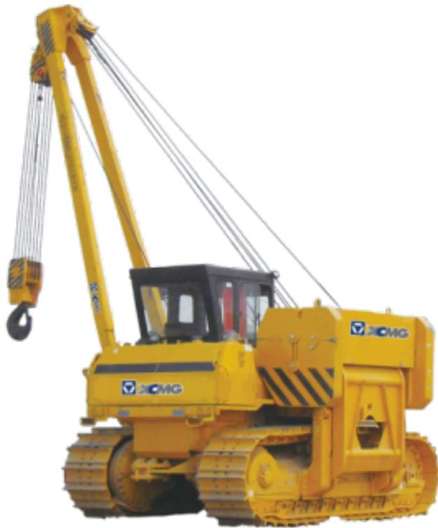
Трубоукладчик XCMG PMG40 - мощная техника с грузоподъемностью 40 тонн, используемая для укладки коммуникаций. Он оснащен мотором с турбонаддувом Cummins NT855-C280 мощностью 230 л.с. и надежной тормозной системой. Эта модель является одним из наиболее востребованных на российском рынке благодаря своей производительности, высокому качеству и доступной цене. Общая масса техники составляет 33 тонны, а дорожный просвет - 450 мм.
