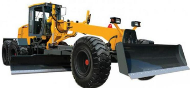
Автогрейдер XCMG относится к землеройно-транспортным машинам. Предназначен для послойной разработки грунта с его поперечным перемещением. Используется в основном для выполнения землеройных и планировочных работ в дорожном строительстве. Автогрейдер XCMG предназначен также и для выполнения работ коммунальных служб, для ремонта и содержания улиц, тротуаров и площадей, а также для выполнения работ по содержанию автомобильных дорог.
