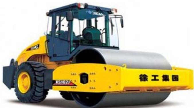
Грунтовый каток XCMG – это супер тяжелый вибрационный каток, который может быть использован для укатки основного и нижнего слоя. Это оптимальный вариант уплотняющего оборудования при строительстве городских дорог, скоростных железных дорог, аэропортов, парковок, портов и плотин. Каток обладает двигателем большой мощности и противоскользкой системой гидропривода, что делает его незаменимым при работах в песчаной местности.
