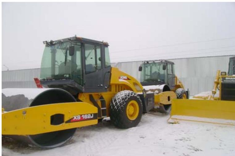
Грунтовый каток XCMG – это супер тяжелый вибрационный каток, который может быть использован для укатки основного и нижнего слоя. Это оптимальный вариант уплотняющего оборудования при строительстве городских дорог, скоростных железных дорог, аэропортов, парковок, портов и плотин. Каток обладает двигателем большой мощности и противоскользящей системой гидропривода, что делает его незаменимым при работах в песчаной местности.
