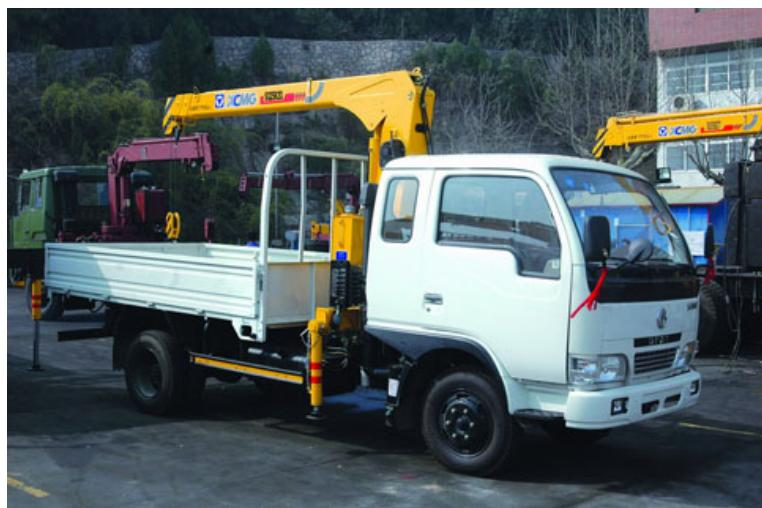
Основная идея, которую воплотили в себя краноманипуляторные установки XCMG - это совмещение двух видов техники в одном: подъемного крана и грузового автомобиля. Задач в этом случае, если объем погрузочно-разгрузочных работ средний, можно решить множество.
