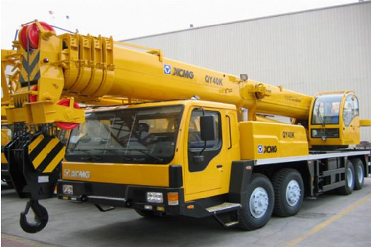
Мобильный колесный кран XCMG сконструирован с использованием принципиально новой гидравлической системы, которая получила в Китае 6 государственных патентов. Колесный автокран XCMG характеризуется отличными показателями проходимости. Низкий центр тяжести обуславливает хорошую устойчивость, как во время движения, так и при выполнении крановых работ.
