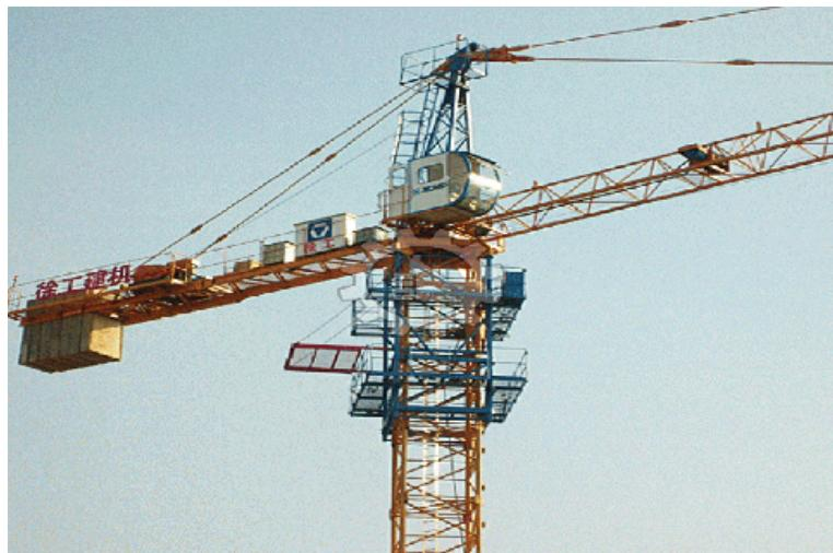
Модель башенного крана XCMG производится для внутреннего внешнего потребления на территории Китая. С незначительными доработками мы поставляем данный кран на наш рынок. Главные части его: башня (коренные и рядовые секции), стрела, контрстрела выполнены из уголка и бесшовных стальных труб, с запасом прочности по уровню сопротивления ветру и сейсмостойкости, в пределах разрешенных температурных режимов для данного вида металлоконструкций и оборудования.
