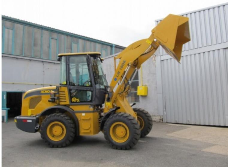
Колесный погрузчик **XCMG LW180K** весом 5600 килограмм имеет грузоподъемность 1,8 тонны. При этом вместимость ковша составляет 0,9-1,1 кубических метра. Управление осуществляется удобным джойстиком.
