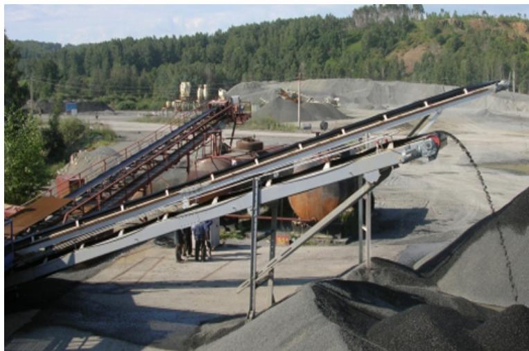
**Ленточные конвейеры бывают следующих типов:**
