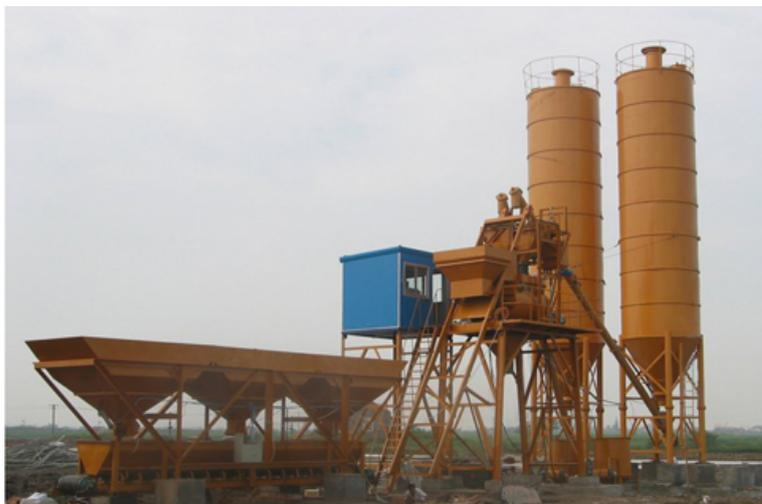
Один из основных товаров нашей компании - автоматизированные все сезонные и летние заводы, производящие раствор и бетон. Заводы выпускаются в стационарной и мобильной модификации, и способны производить от 25 до 90 кубометров бетонного раствора в час.
