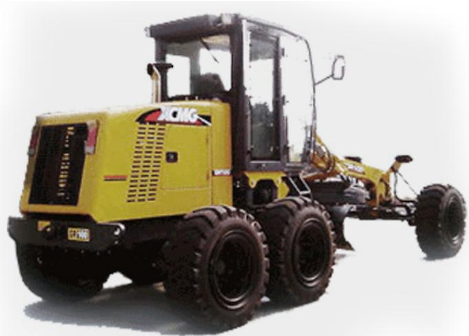
Автогрейдер XCMG относится к землеройно-транспортным машинам. Предназначен для послойной разработки грунта с его поперечным перемещением. Используется в основном для выполнения землеройных и планировочных работ в дорожном строительстве. Автогрейдер XCMG предназначен также и для выполнения работ коммунальных служб, для ремонта и содержания улиц, тротуаров и площадей, а также для выполнения работ по содержанию автомобильных дорог.
